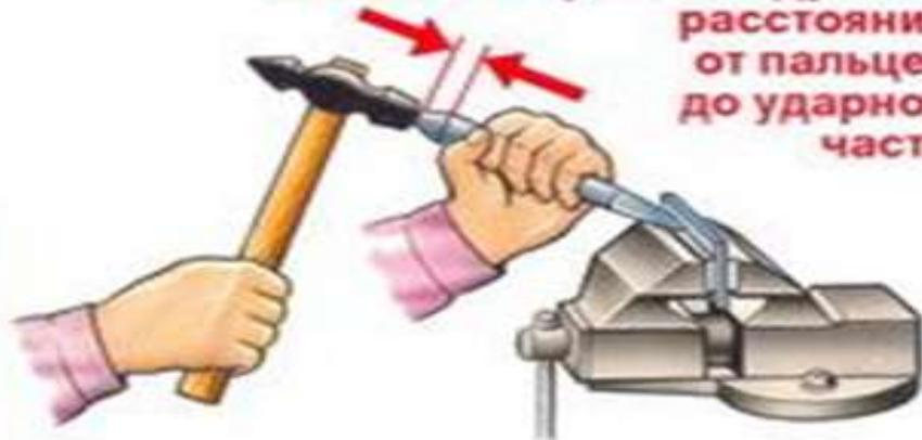
Не уменьшай угол наклона зубила к плоскости губок тисков менее 30-35°. Возможен срыв зубила и травма руки
