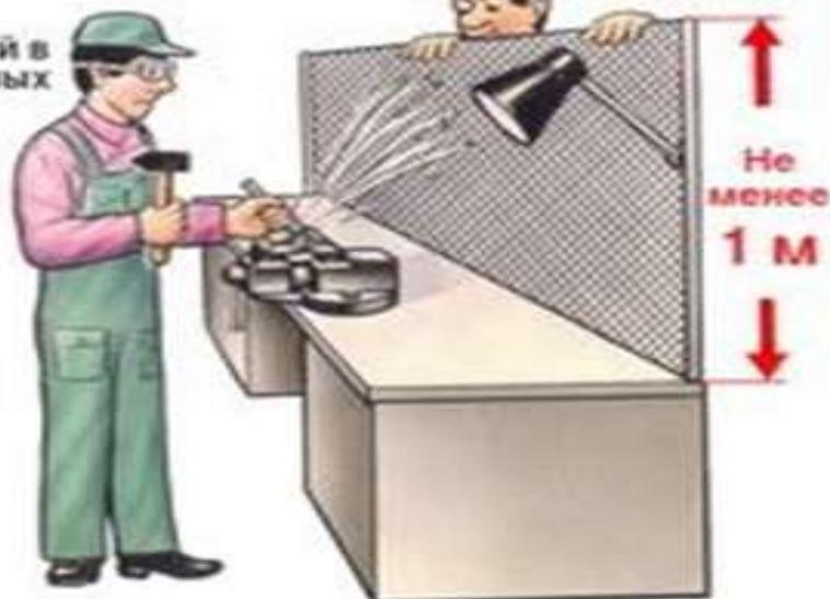
Следи, чтобы отрубаемые куски отлетали только в сторону защитного экрана
