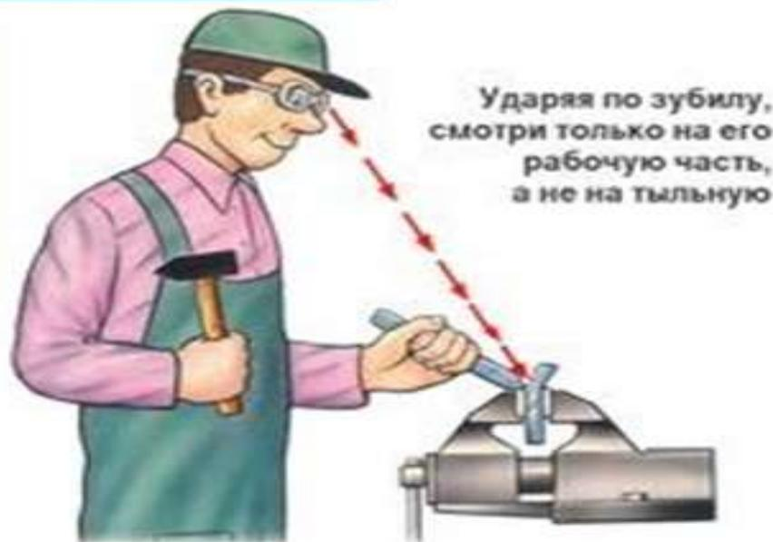
Ударяя по зубилу, смотри только на его рабочую часть, а не на тыльную
